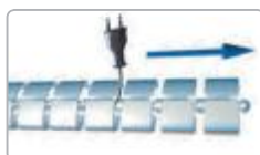
Easy-Zip Installation sans outils sur le mode de la fermeture éclair
